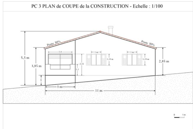
**Objectif : exposer l'adaptation de la construction au terrain, à la pente en particulier.**
